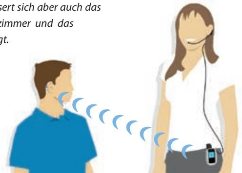
Die FM-Anlage funktioniert nach dem Sender-Empfänger-Prinzip.
